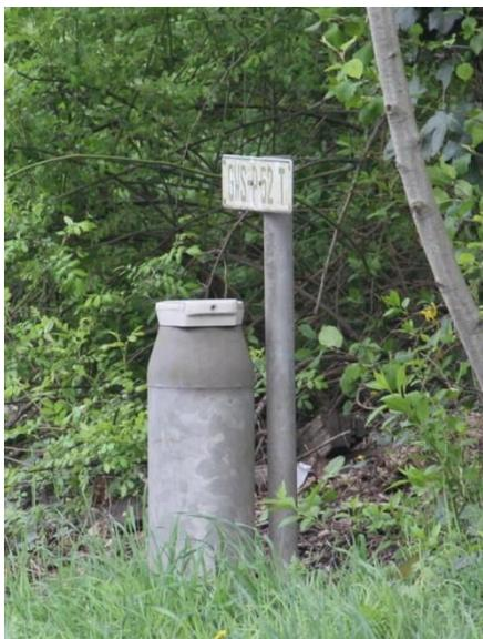
Die Messbrunnen, die eine starke Grundwasserbelastung unter der Deponie Hubbelrath nachwiesen wurden einfach mit der Erhöhung der Deponie ausgebaut.
